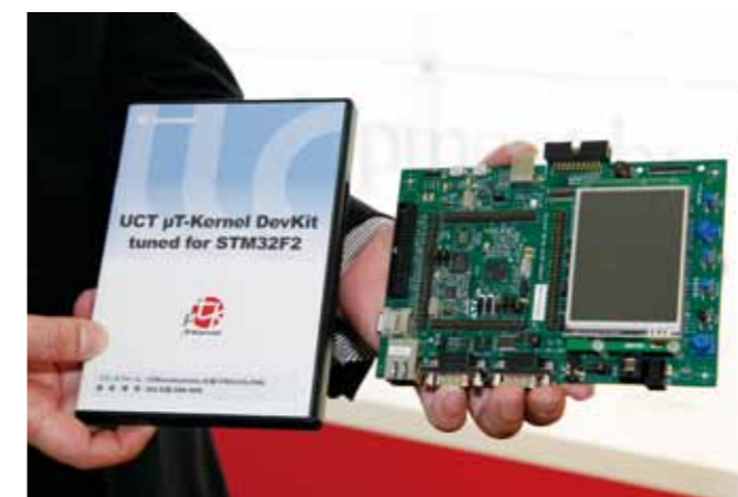
図：STM32F2用にチューニングされたμT-Kernel DevKitと(左) ST製の評価ボードSTM3221G-EVAL(右)
