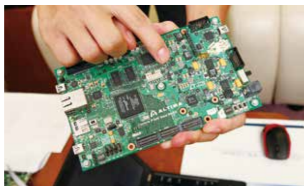
電源マネージャICを搭載により、消費電力もモニタリングできる。
