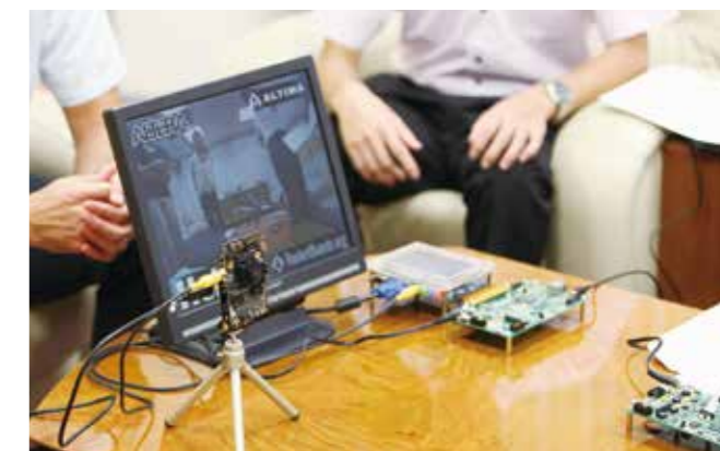
画像処理のデモ。Linux上のアプリケーションで処理したのちLCDに出力。
