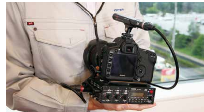
図1：「DC-R302」にデジタルカメラとエレクトレットコンデンサーマイクMC10STを接続した例。
