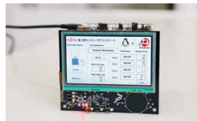
図2：フリースケール・セミコンダクタ社製「Vybrid Tower System モジュール」を用いたLinuxとμT-KernelのマルチOSのデモ。
