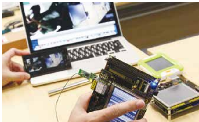
図3：N3292xの評価キット。2つのCMOSセンサーが接続されており、WiFiでPCや携帯に画像を転送するデモ。
