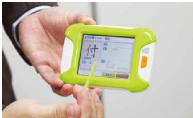
図2：学習雑誌の年間購読者に向けた付録。N3290xのN32905U1DNが採用されており、マイコンの省エネ性から単三電池2本で1カ月以上も使える（使用頻度による）。
