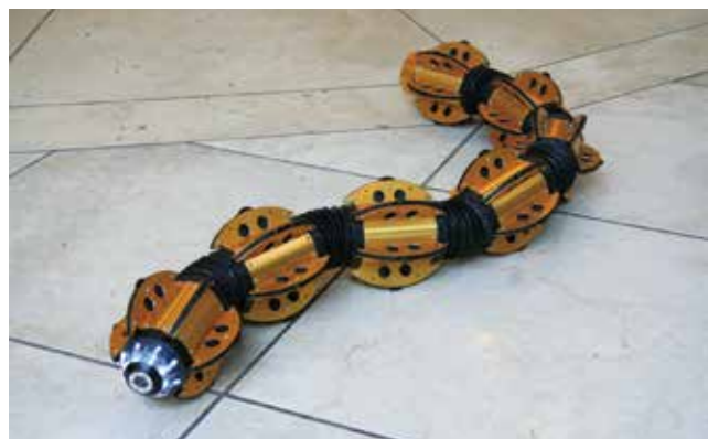
図2：水陸両用ヘビ型ロボット「ACM-R5」。メインコントローラに「STM32 F4」を、各関節部分のモーター制御用に「STM32 F3」を採用。
