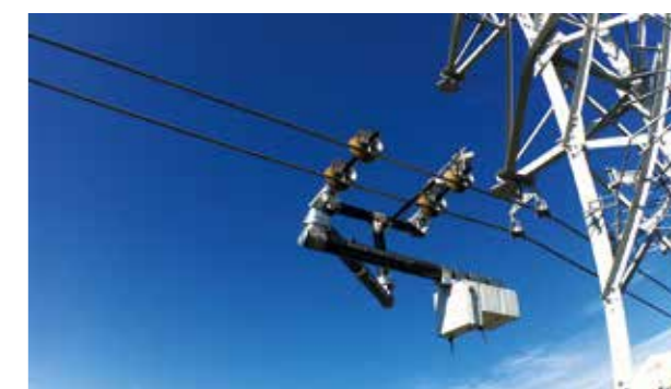
図1：超高压架空送電線点検ロボット「Expliner」。メインコントローラに「STM32 F4」、モーター制御には今後「STM32 F0」に切り替えを予定。
