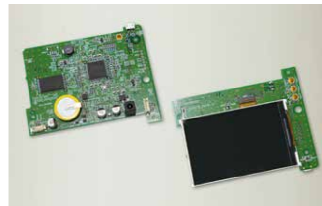
図3: N329ファミリの採用により、部品点数の削減にも貢献。
