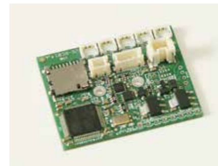
図：STM32F205RBT6搭載「Robi」センターボード。
