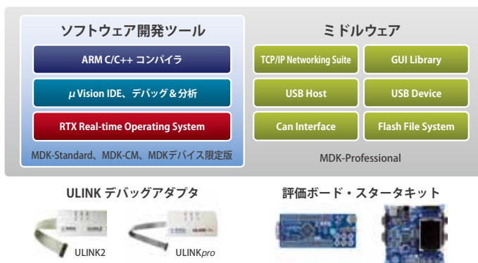
図2 : MDK-ARM開発システム
