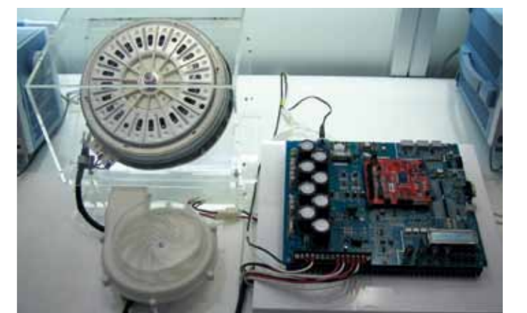
図4：モータ技術展に出展した2モータ制御のリファレンスモデル
